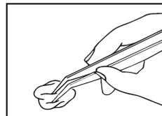
**2** 剥離紙の広い側のタブをゆっくりと引き、接着面を半分ほど出して下さい。この際接着面に触れない様注意して下さい。
